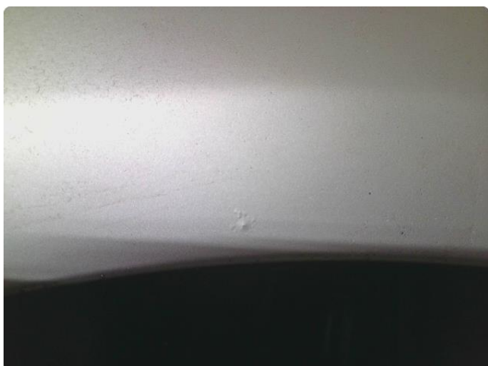
1.3 Steinsprut med rust
