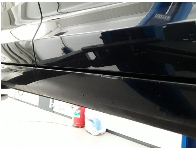
1.5 Liten ripe på høyre kanaldeksel. Normal bruksslitasje
