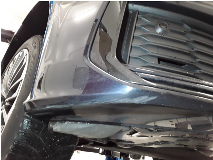
1.3 Noe skrubbskade underkant støtfanger foran.
