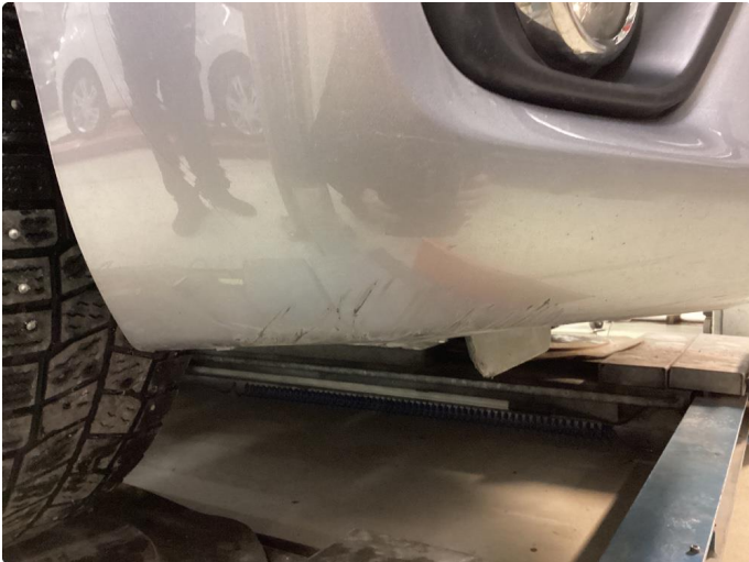
1.1 Liten skade/sprekk på frontfanger H.Foran
