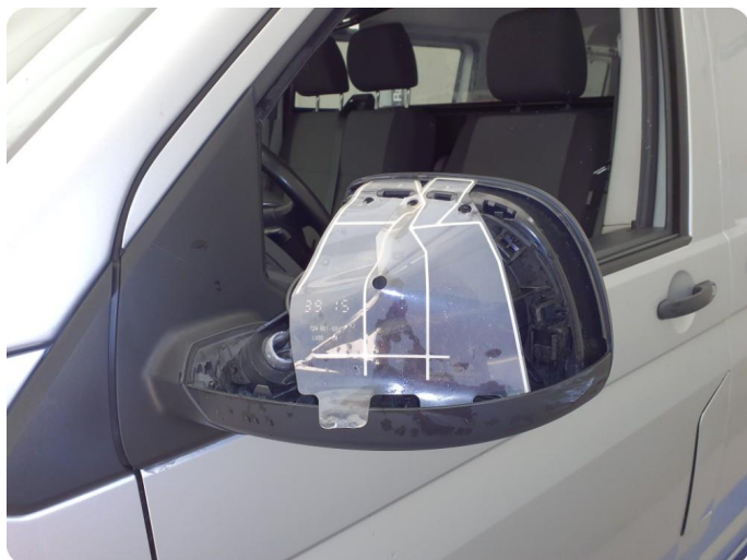
2.5 Deksel mangler Deksel ligger inni dørpanel deffekt
