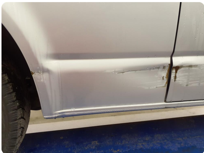
2.4 Steinsprut med rust Tillegg skade h.bak
