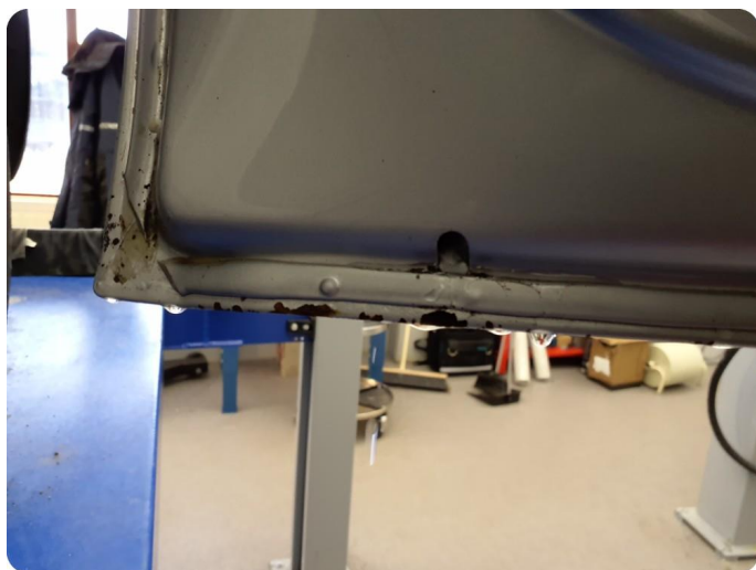
2.1 Lakk flasser Tillegg ripe og skade bak
