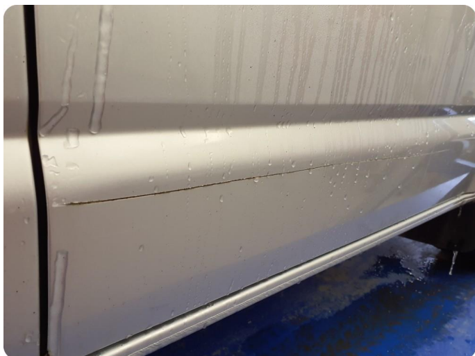
2.1 Lakk flasser Tillegg ripe og skade bak
