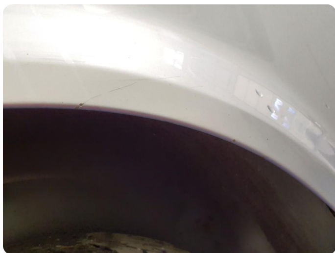
2.4 Steinsprut med rust Tillegg skade h.bak
