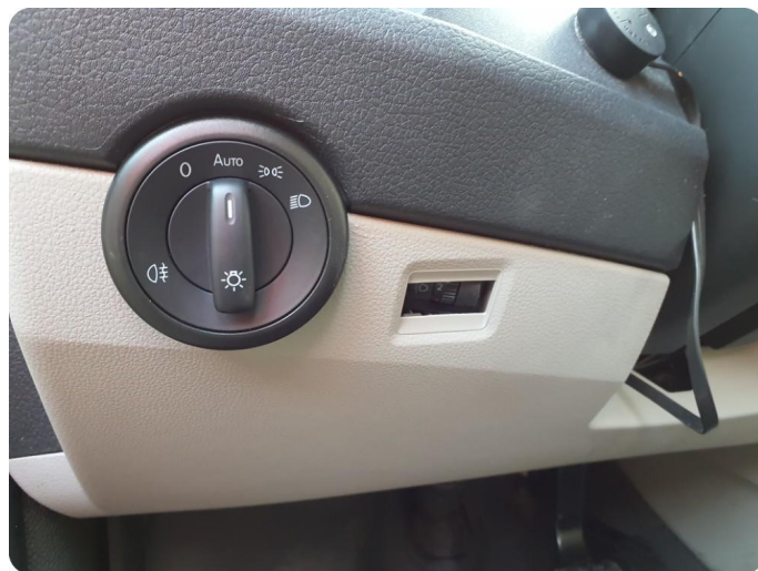
4.1 Skadet/merker etter utstyr Bryter til lyshøyde ligger løs inni dashbord, må kontrolleres
