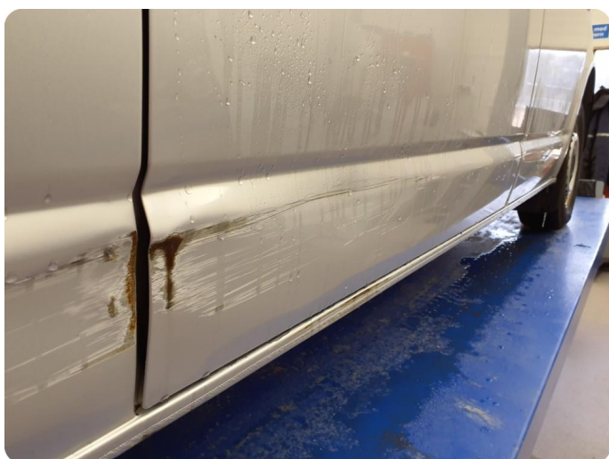
2.1 Lakk flasser Tillegg ripe og skade bak
