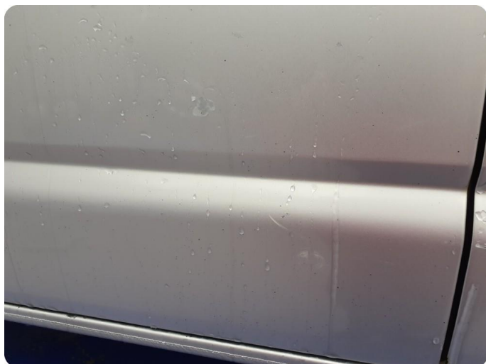
2.1 Lakk flasser Tillegg ripe og skade bak
