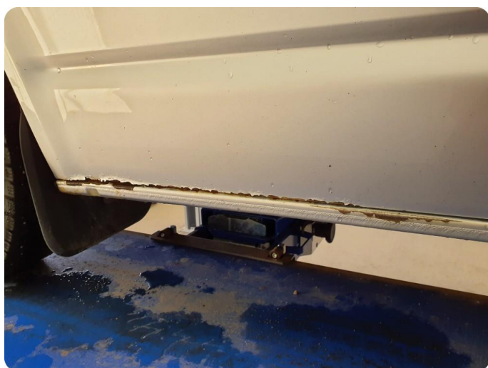
2.1 Lakk flasser Tillegg ripe og skade bak
