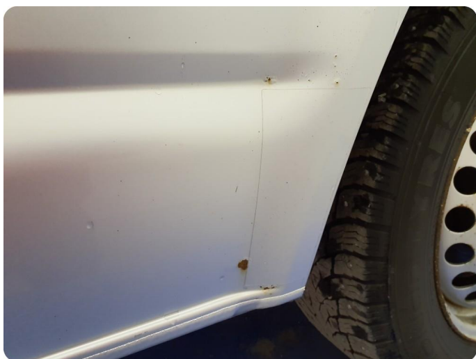
2.4 Steinsprut med rust Tillegg skade h.bak
