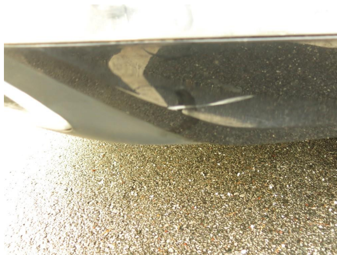
1.2 Ripe(r) ned til grunning
