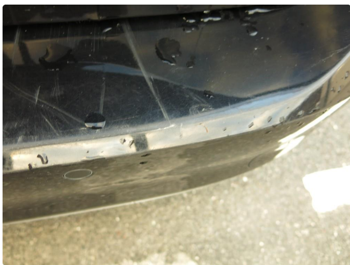
1.2 Ripe(r) ned til grunning
