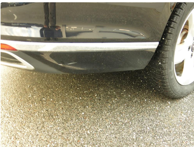
1.2 Ripe(r) ned til grunning
