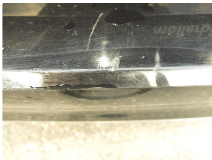
1.2 Ripe(r) ned til grunning
