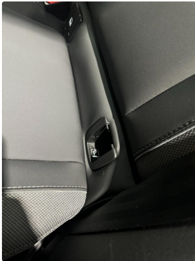
2.1 Mangler et lokk
