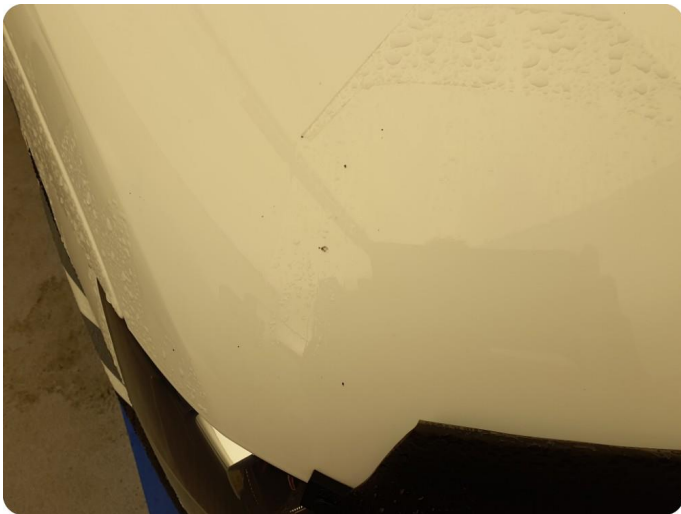
1.2 Steinsprut Må kontrolleres
