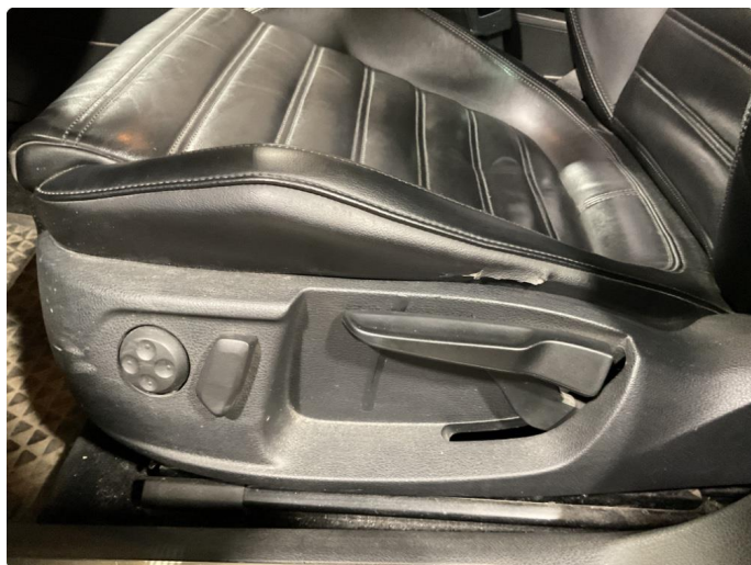
3.2 Skade på setetrekk
