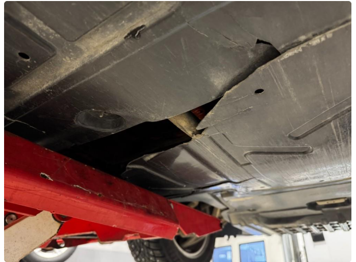
2.1 Skade på plast deksel under bil
