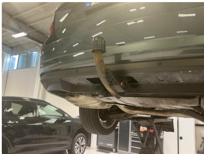
3.1 Defekt utløser på avtagbart hengerfeste. Kan ikke tas av. Selges som fast hengerfeste !
