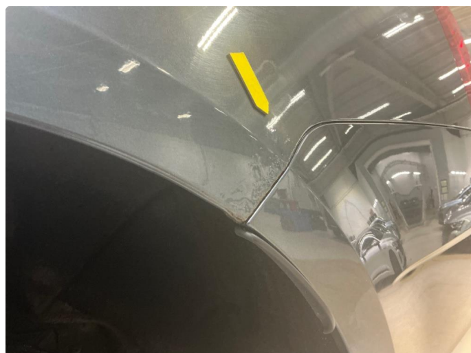
1.1 Noe rust begge bakskjermer og forskjermer
