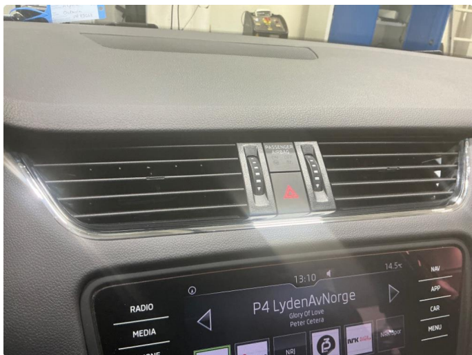
2.1 Defekt luftdyse foran i midten.
