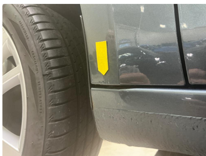
1.1 Noe rust begge bakskjermer og forskjermer
