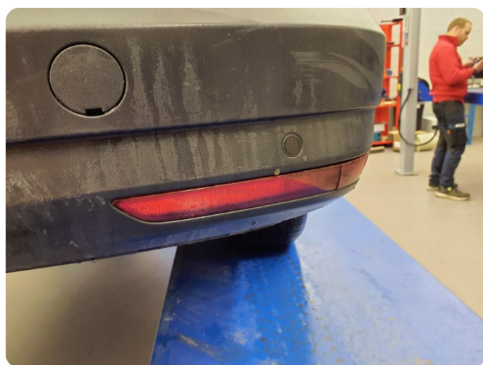
3.9 Skade Riper bak og knust refleks h.bak
