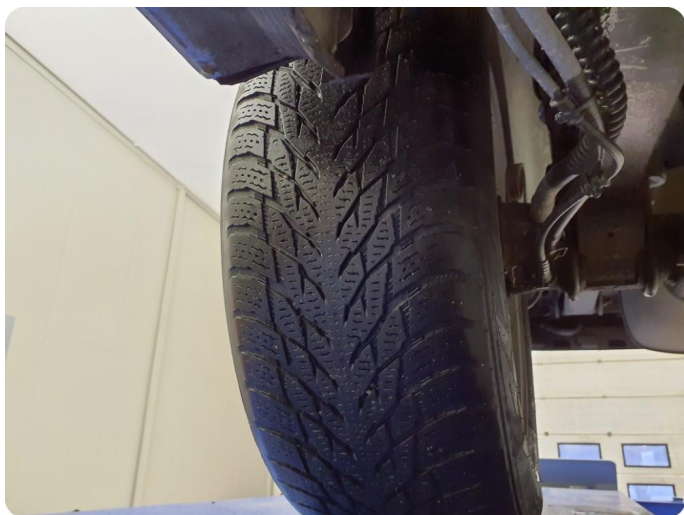
3.7 Øvrige feil Alle 4 dekk er kjørt med for lite luft
