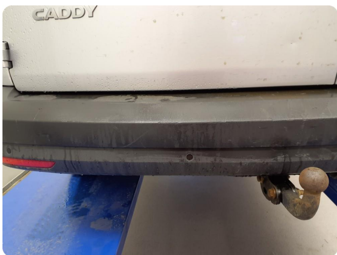
3.9 Skade Riper bak og knust refleks h.bak
