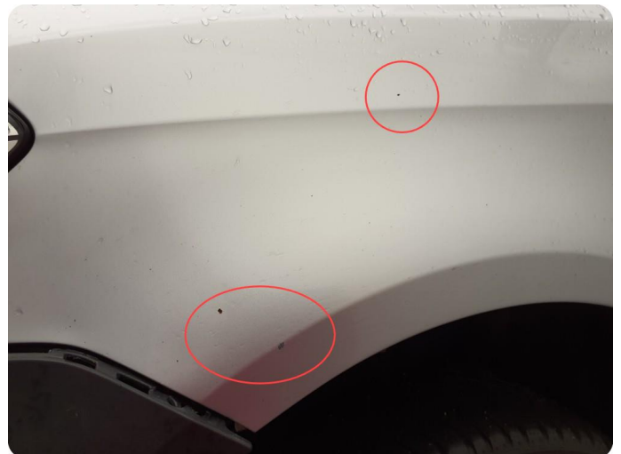
3.4 Ripe(r) ned til grunning Tillegg rust og steinsprut
