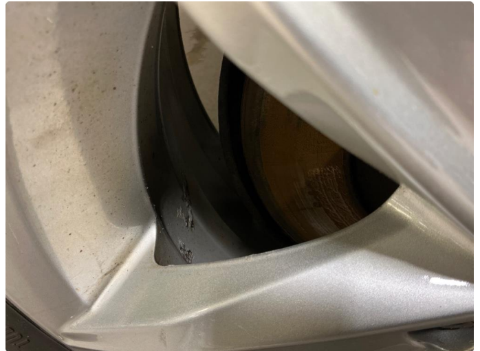
1.2 Noe korrosjon på vinterfelger .
