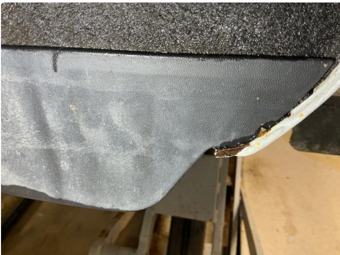
1.3 Høyre og venstre kanal/hjulbue foran bakhjul - rust
