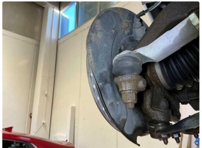
2.1 Rust på bremseskjold
