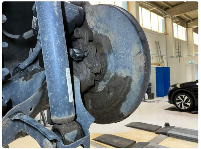
2.1 Rust på bremseskjold
