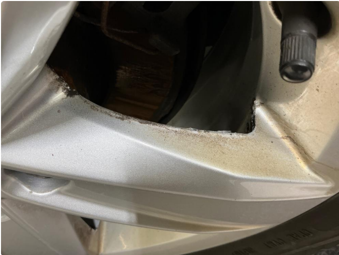
1.2 Noe korrosjon på vinterfelger .
