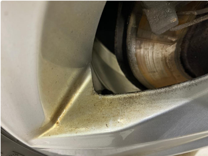
1.2 Noe korrosjon på vinterfelger .
