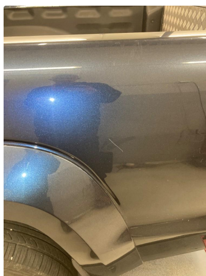
2.3 Ripe(r) ned til grunning
