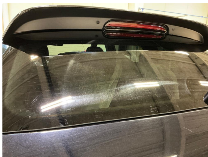
1.4 Bakvindu - mekanisk slitasje etter visker - ok
