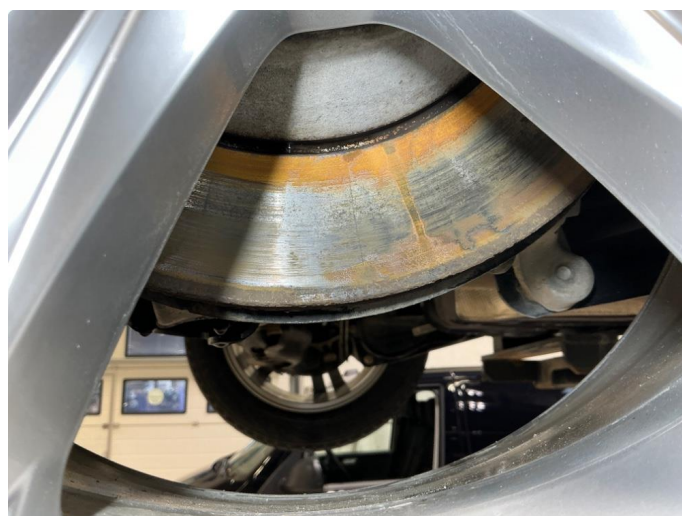
2.1 Noe slitekant og litt overflatrust skiver foran og bak
