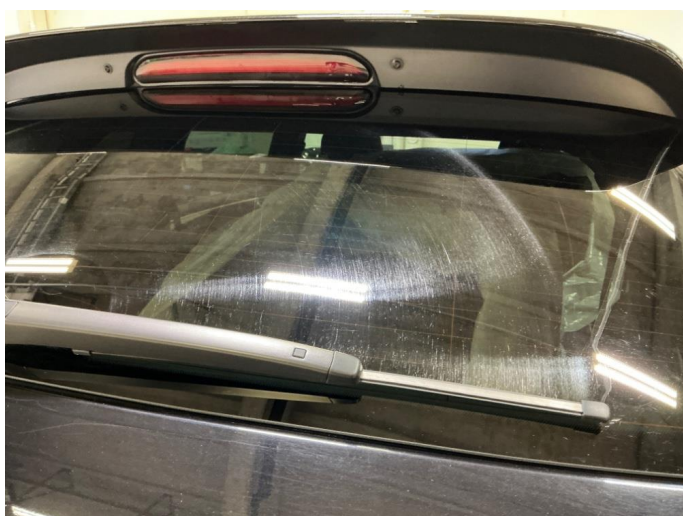
1.4 Bakvindu - mekanisk slitasje etter visker - ok
