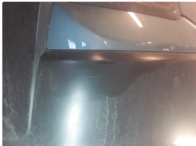
1.3 Noe riper nedre del av støtfanger bak.
