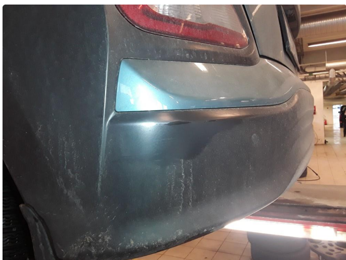
1.3 Noe riper nedre del av støtfanger bak.
