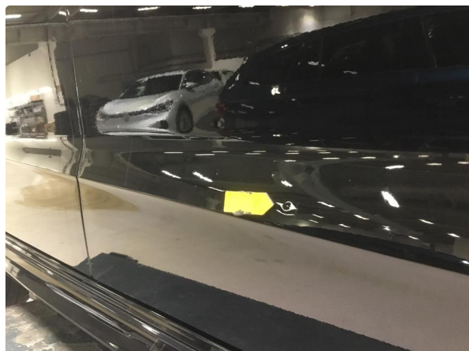
1.1 Liten bulk høyre dør foran
