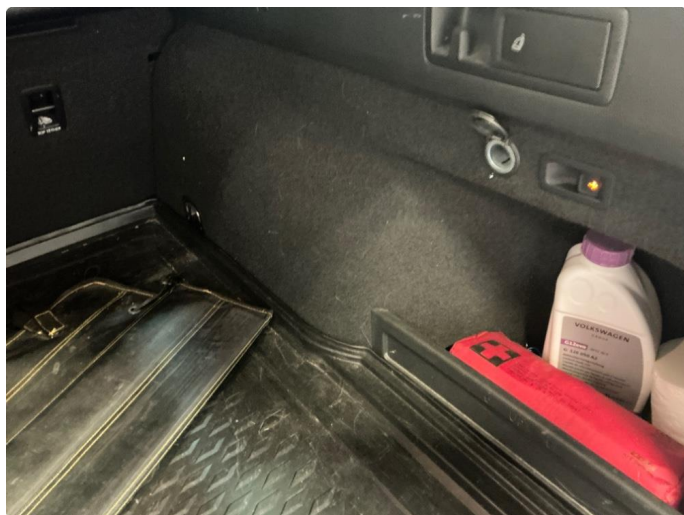
2.3 Defekt lokk 12 v uttak bagasjerom.
