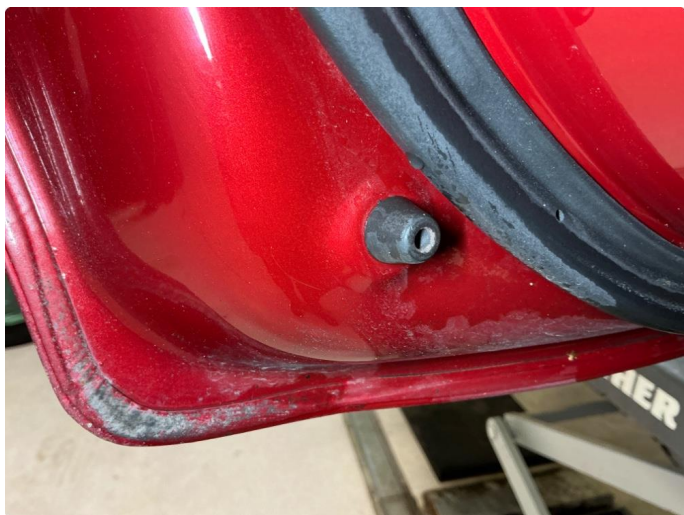
1.5 Venstre bakdør - gnisseskade fra dør
