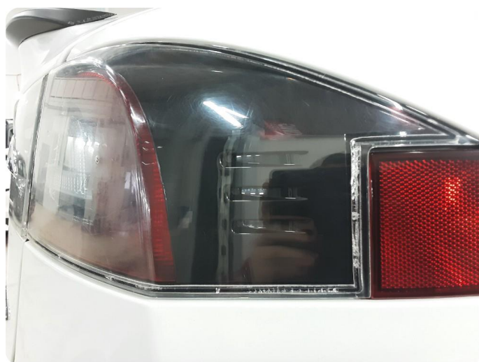
4.1 Krakelering i plast
