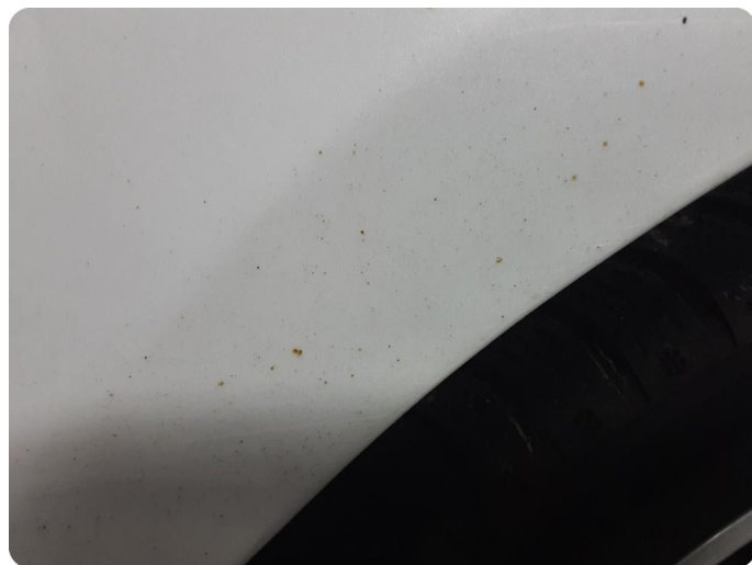
3.11 Ripe(r) ned til grunning
