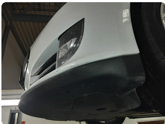
3.19 Ripe(r) ned til grunning
