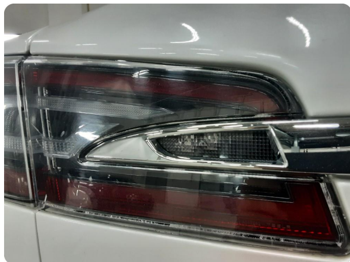
4.1 Krakelering i plast
