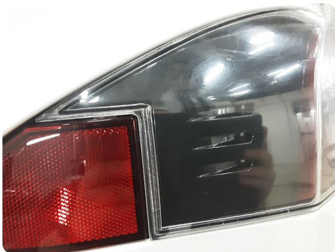
4.1 Krakelering i plast
