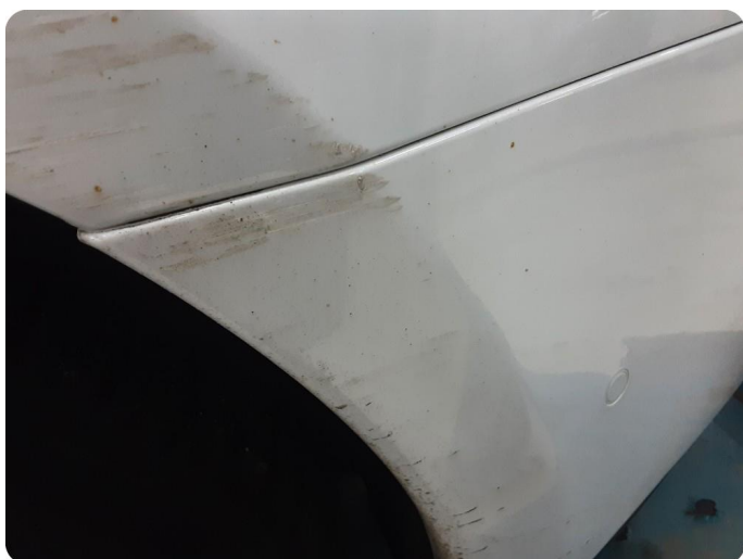
3.18 Ripe(r) ned til grunning
