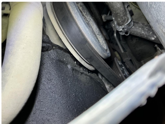
2.1 Noe oljesvetting fra bunnpanne ved reimhjul bakkant motor - ok
