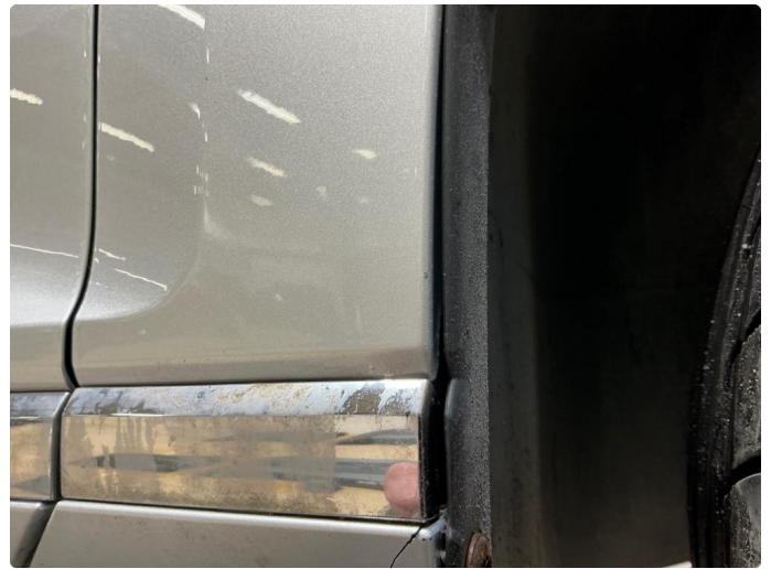
1.7 Høyre skjerm foran - noe rustblærer
