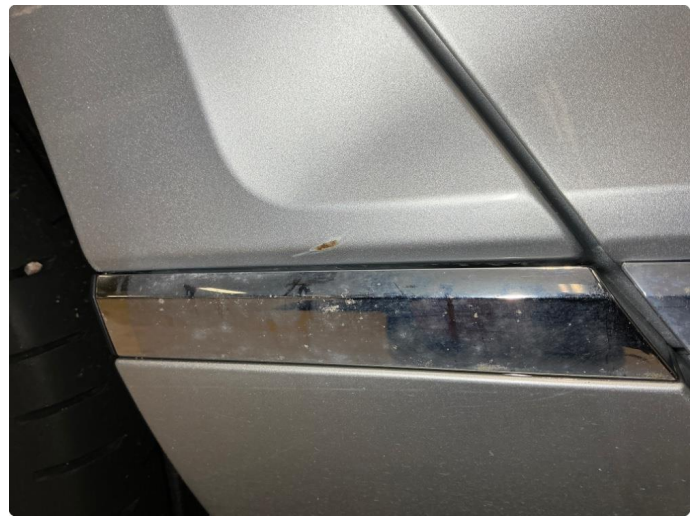
1.5 Rust Høyre bakskjerm
