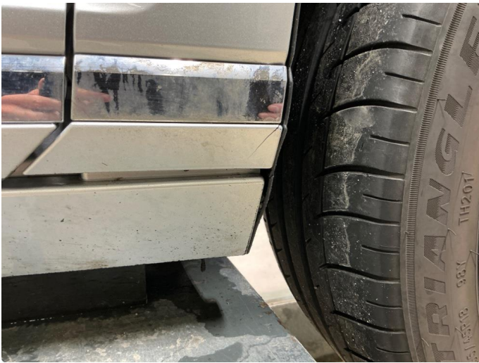
1.6 Høyre skjerm foran - sprekk i sidelist
