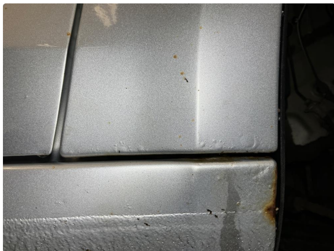
1.6 Høyre forskjerm rust
