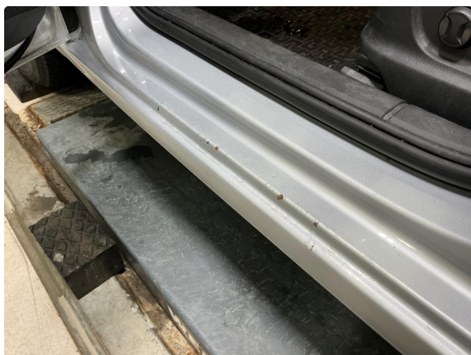
1.12 Venstre innsteg foran slitt gjennom lakk
