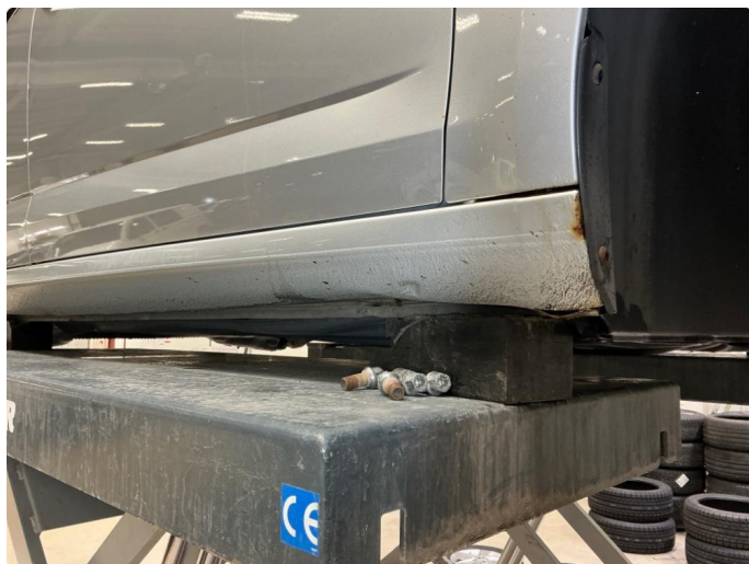
1.15 Høyre kanal - bulk/rust - bulk
