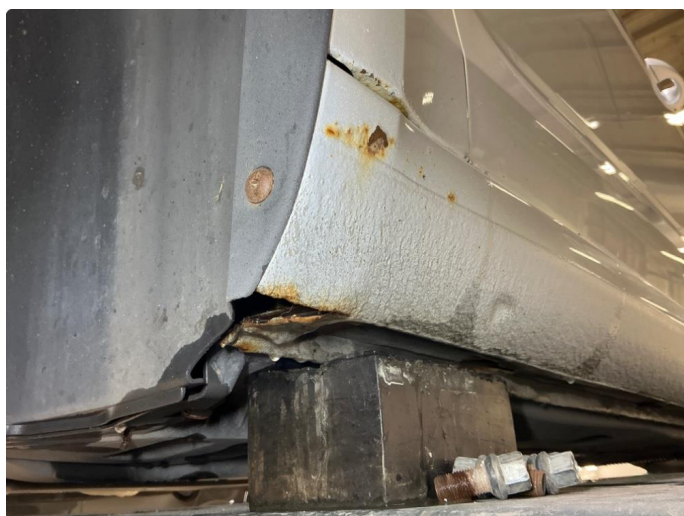
1.16 Kanal venstre side - rust
