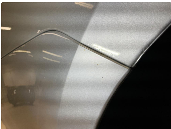
1.7 Høyre bakskjerm rust
