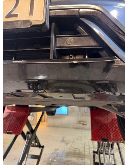
1.2 Skrapeskade nederst på frontfanger
