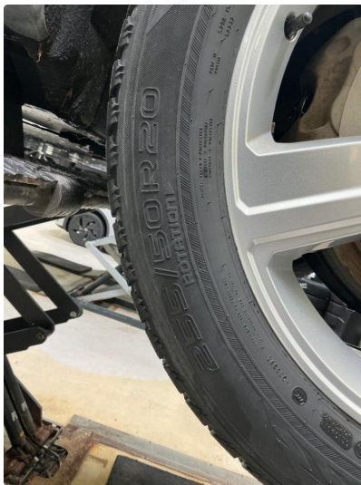
1.2 Skjev slitasje på vinterdekk, 4 hjulskjett er utført
