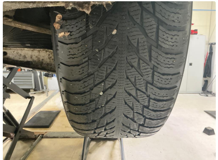
1.2 Skjev slitasje på vinterdekk, 4 hjulskjett er utført
