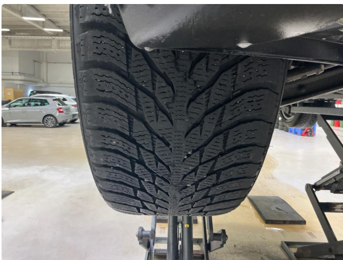
1.2 Skjev slitasje på vinterdekk, 4 hjulskjett er utført
