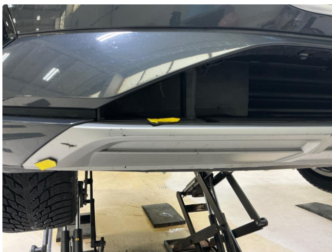
1.4 Luftgitter i støtfanger foran og skrubbskader underkant av støtfanger foran - skrubbskader pensles
