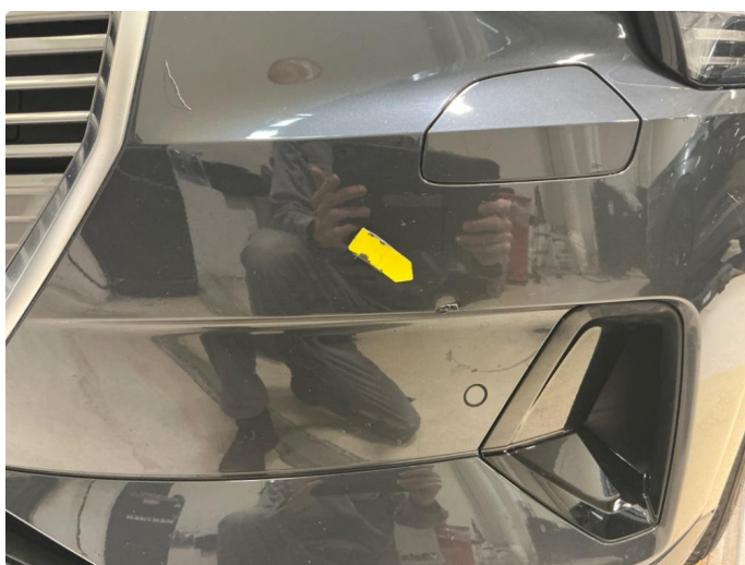
1.6 Liten skade støtfanger foran
