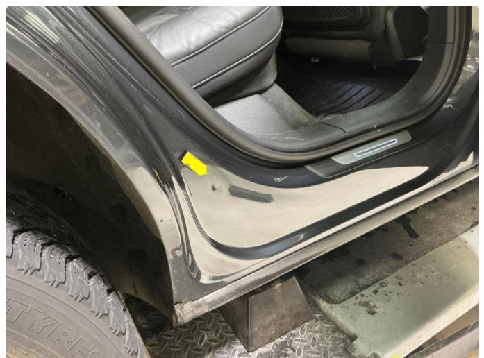
1.3 Bulk, høyre innsteg bak
