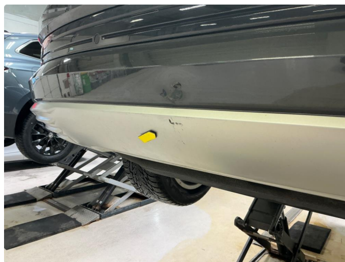
1.5 Lakksår diffusor til støtfanger bak
