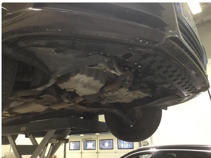
1.1 Mangler beskyttelsesplate under motor
