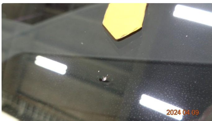
1.5 Tidligere reparert steinsprut i frontruten - OK
