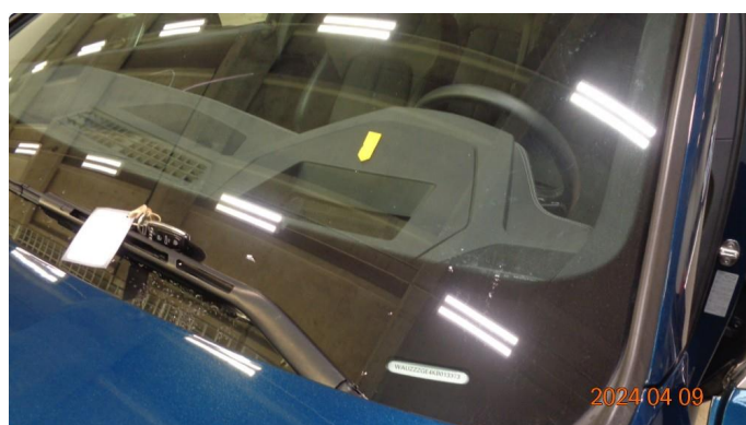
1.5 Tidligere reparert steinsprut i frontruten - OK
