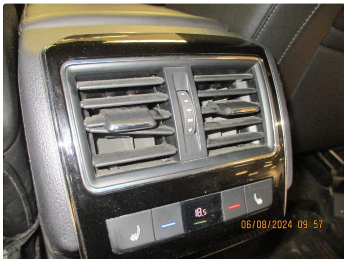
2.1 Defekt luftdyse bak
