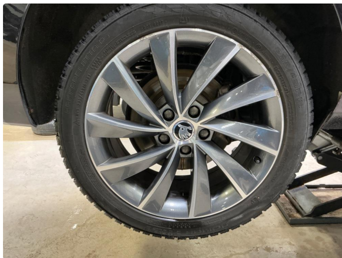
1.8 Vinterfelger er korroderte.
