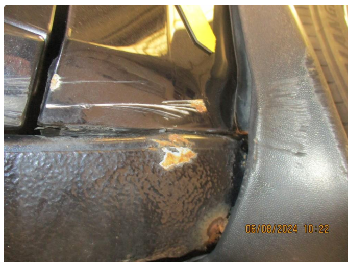
1.4 Bulk med lakkskade
