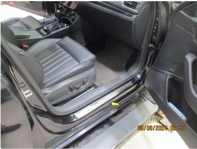
1.9 Rust innsteg h.foran. Slitt...
