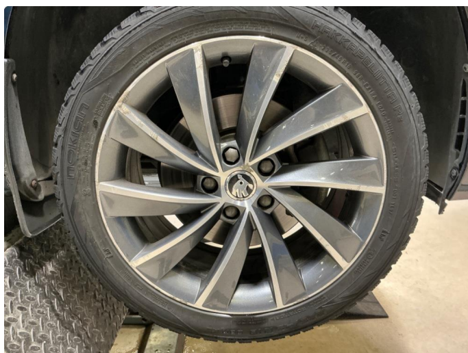
1.8 Vinterfelger er korroderte.
