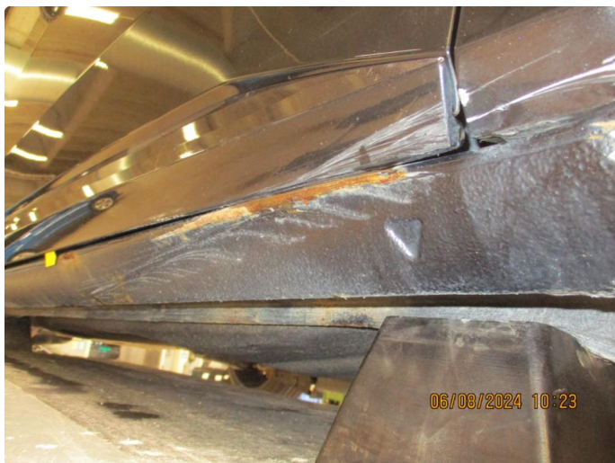
1.13 Bulk med lakkskade.
