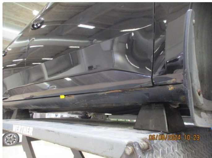
1.13 Bulk med lakkskade.
