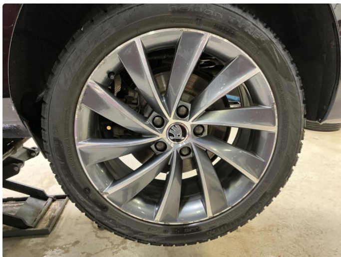
1.8 Vinterfelger er korroderte.
