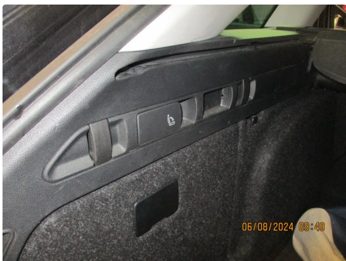
2.2 Lekk 12 v uttak i bagasjerom + Lampe v.s i bagasjerom mangler
