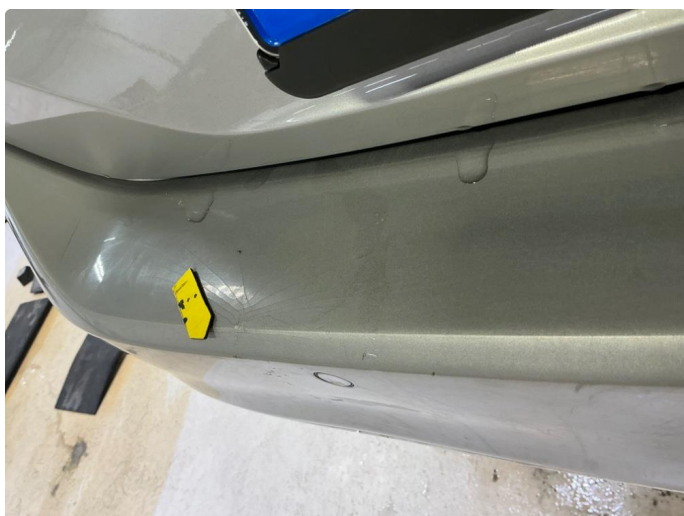
1.8 Bulk med sprekk i lakk.
