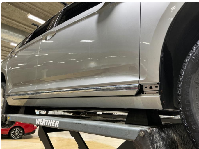
1.11 Fremre kanaldeksel h.s mangler.
