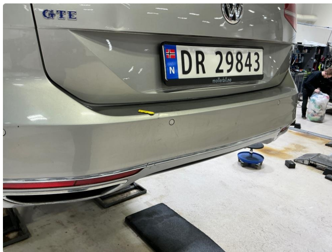
1.8 Bulk med sprekk i lakk.
