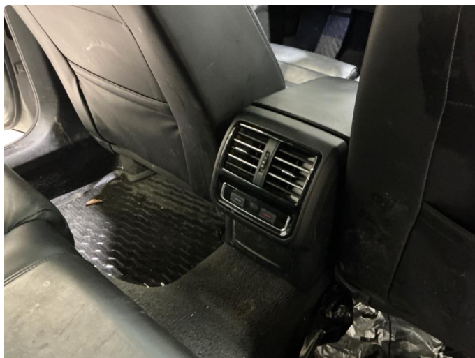
3.1 Defekt luftdyse midtkonsoll bak.
