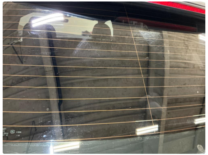
1.9 Mekanisk slitasje og riper i bakvindu
