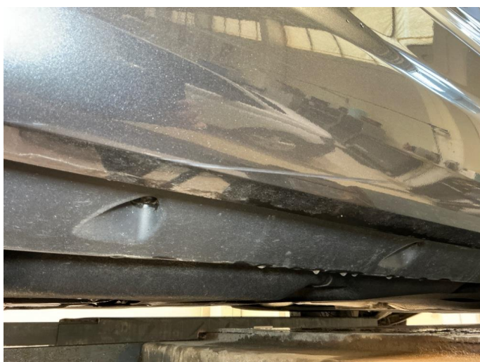
1.3 Høyre bakdør nedre plastdetalj , ripe ned til grunning
