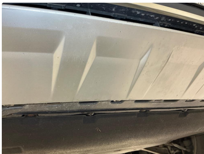
1.7 Fanger foran, skrubbskader underkant
