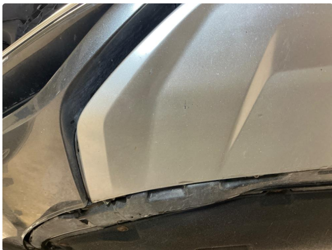
1.7 Fanger foran, skrubbskader underkant
