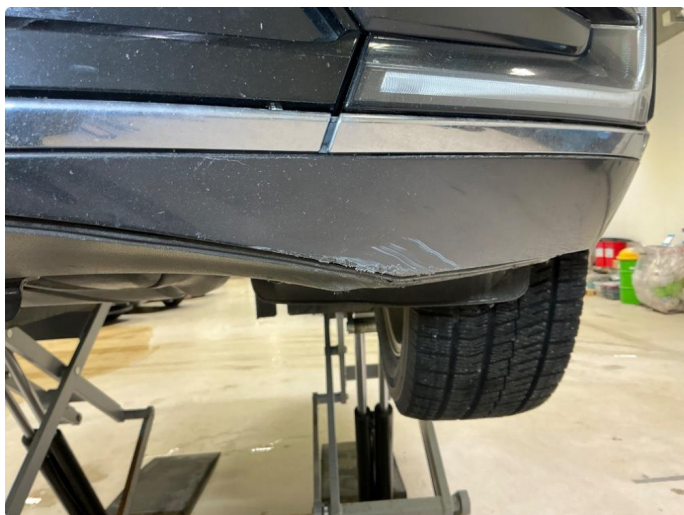
1.12 Skrubbskader underkant , Høyre og venstre side foran
