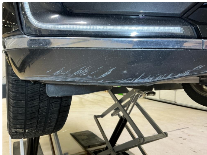
1.12 Skrubbskader underkant , Høyre og venstre side foran
