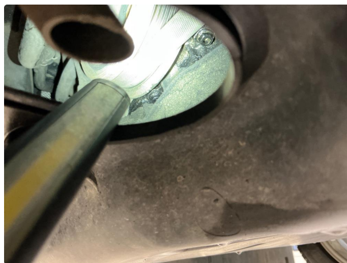
2.1 Oljesvetting fra bunnpanne ved reimhjul
