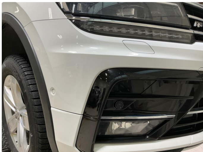
1.8 Det er utført en smartrepair h.fangerhjørne foran.
