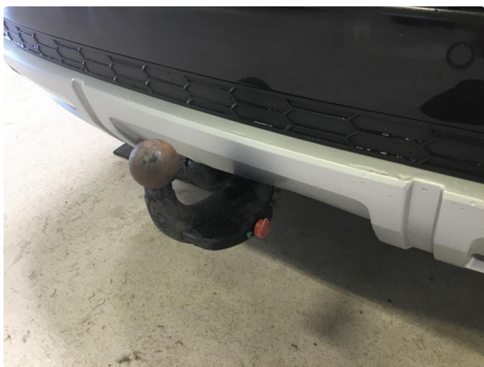
2.1 Kilt mekanisme hengerfeste.Selges som "fast"hengerfeste.
