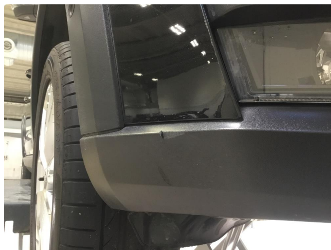
1.6 Høyre side foran - sår i plast
