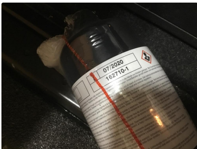
1.5 Dekktemiddel utgått på dato
