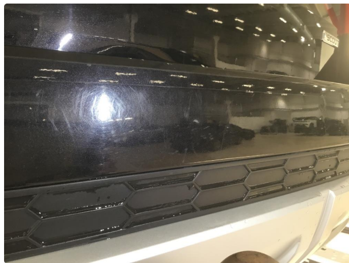
1.7 Bakfanger - mekanisk slitasje .
