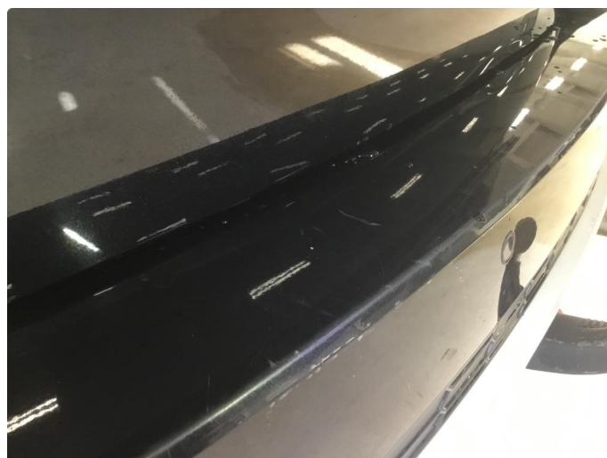
1.7 Bakfanger - mekanisk slitasje .
