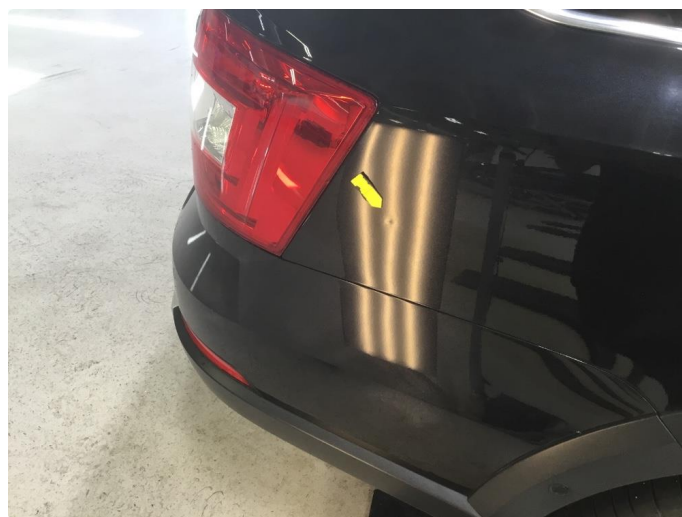
1.4 Høyre bak - bulk
