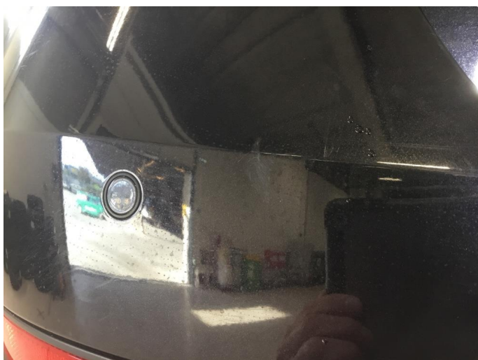
1.7 Bakfanger - mekanisk slitasje .
