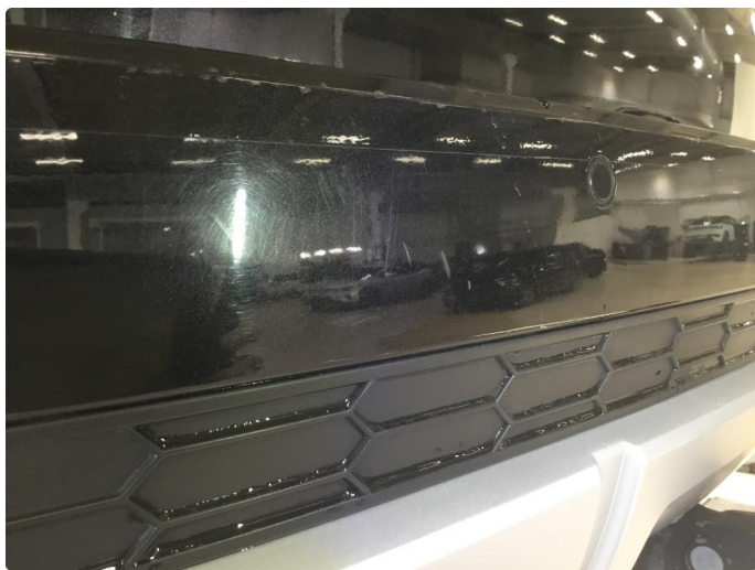
1.7 Bakfanger - mekanisk slitasje .
