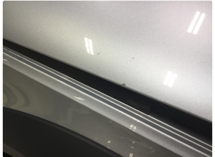
1.1 Steinsprut / sår panser
