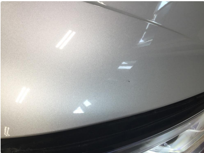
1.1 Steinsprut / sår panser
