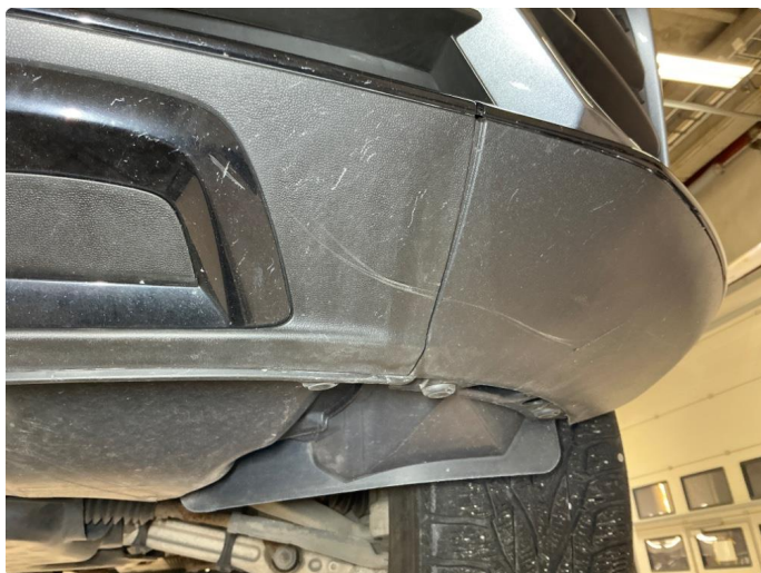
1.7 Fanger foran , skrubbskader underkant
