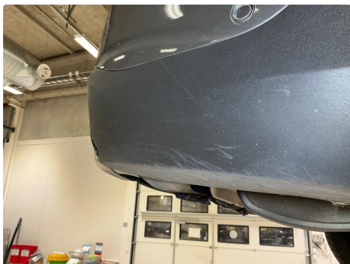
1.8 Fanger bak høyre side , skrubbskader underkant
