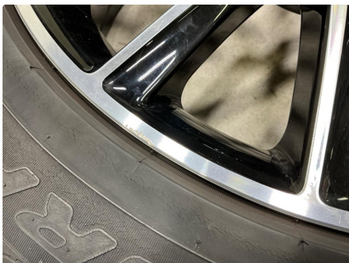
1.2 Kantkjøringer og sår på sommerhjul
