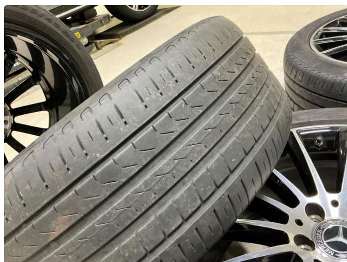
1.3 Skjev slitasje på sommerdekk . 4 hjulskontroll utføres.
