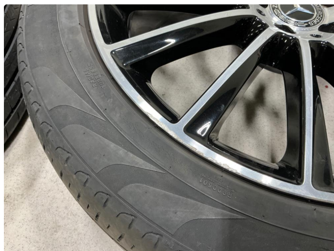
1.2 Kantkjøringer og sår på sommerhjul
