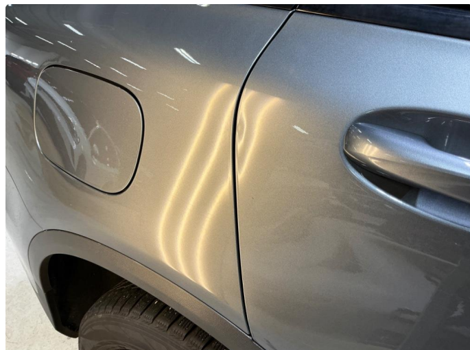
1.1 Høyre bakdør bulk
