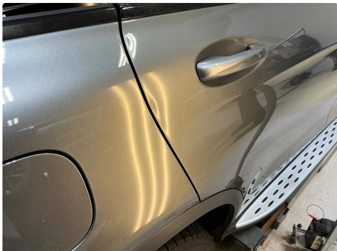
1.1 Høyre bakdør bulk
