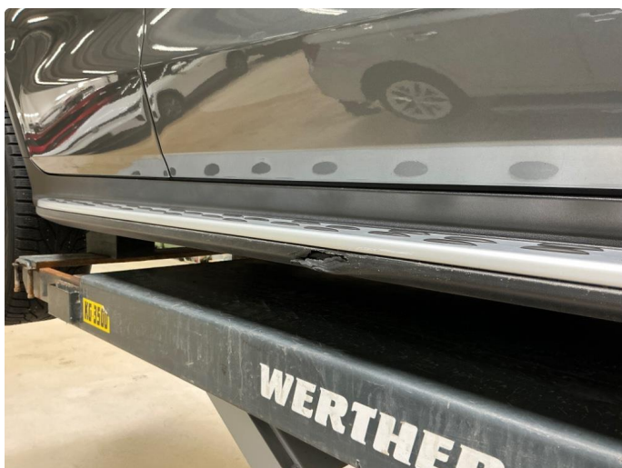
1.6 Stigtrinn skadet høyre side
