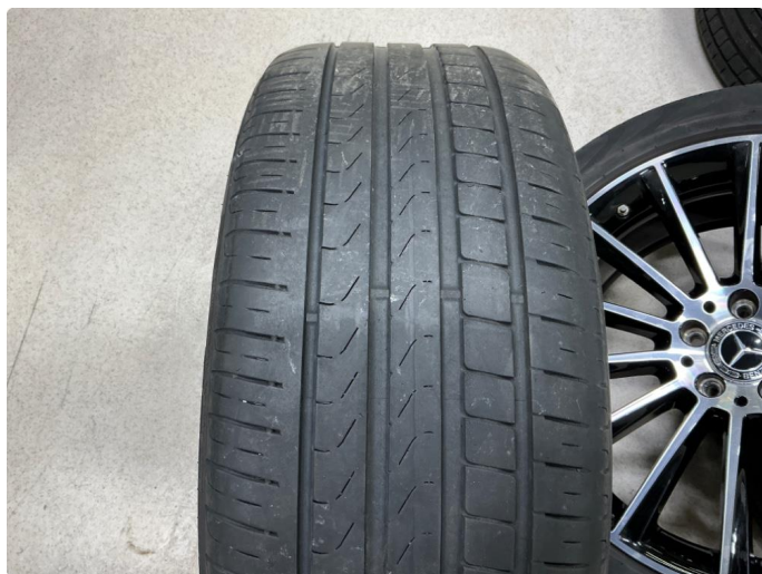
1.3 Skjev slitasje på sommerdekk . 4 hjulsk kontroll utføres.
