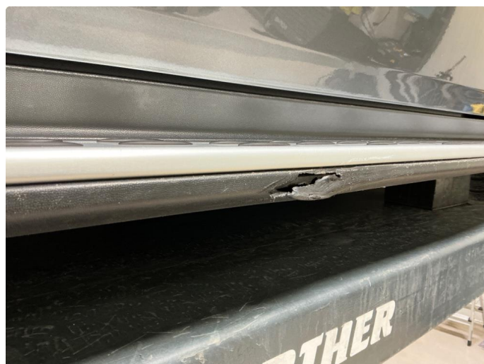
1.6 Stigtrinn skadet høyre side
