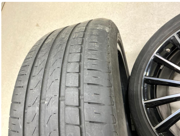
1.3 Skjev slitasje på sommerdekk . 4 hjulsk kontroll utføres.
