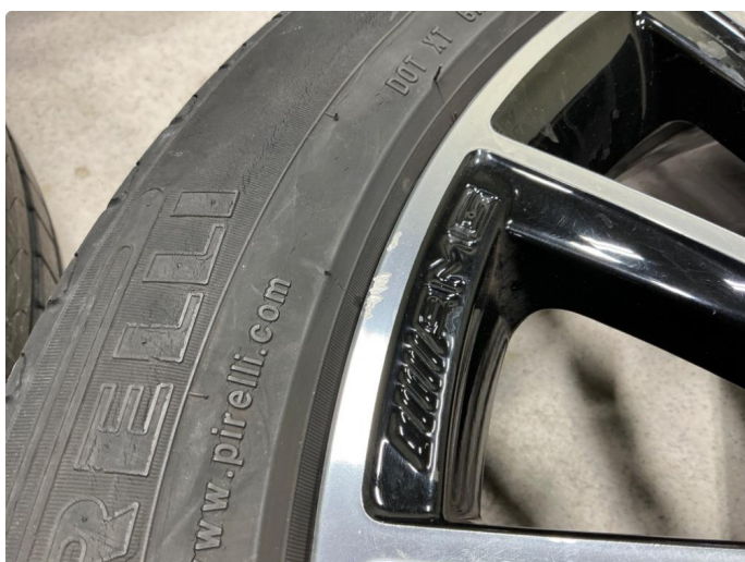
1.2 Kantkjøringer og sår på sommerhjul
