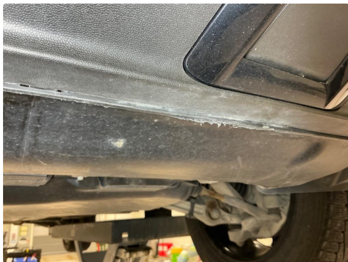
1.7 Fanger foran , skrubbskader underkant
