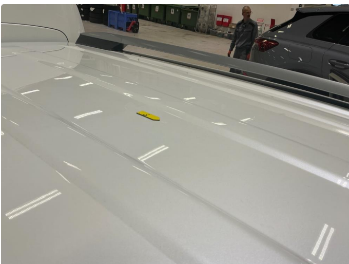
1.5 Blære tak, rust
