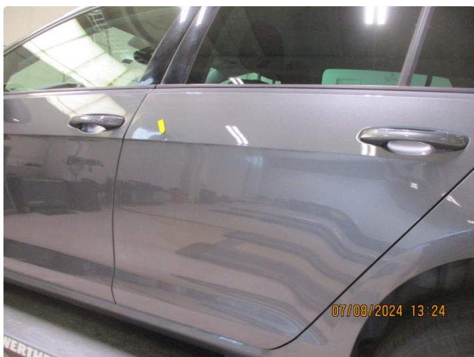
1.2 P-bulk med lakkskade
