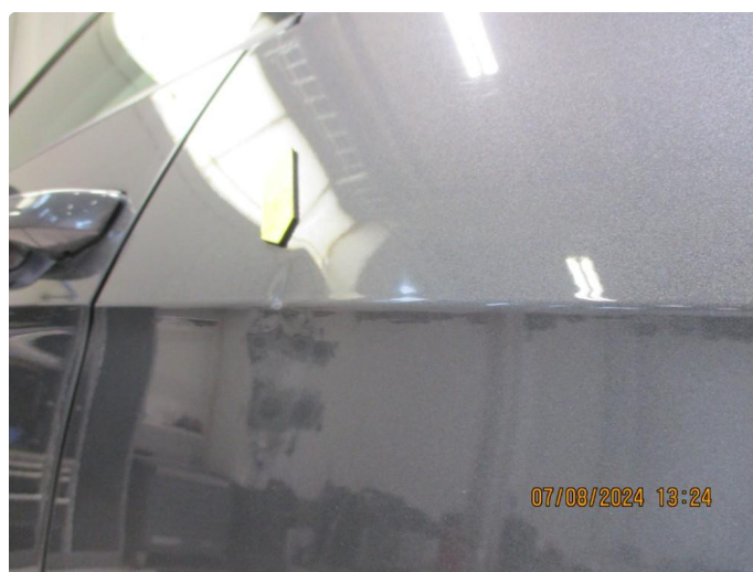
1.2 P-bulk med lakkskade
