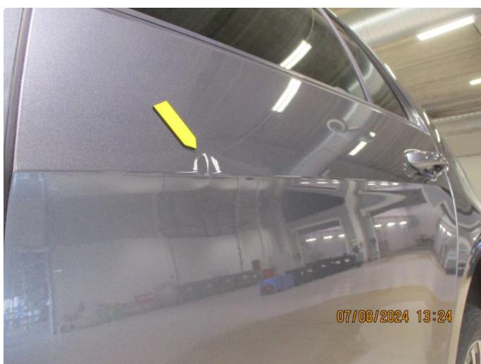
1.2 P-bulk med lakkskade
