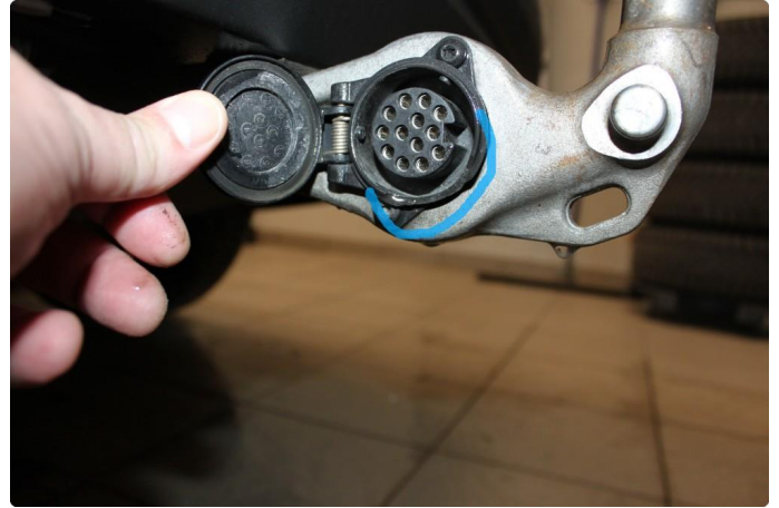
2.1 Tilhengerkontakt - innfesting skadet
