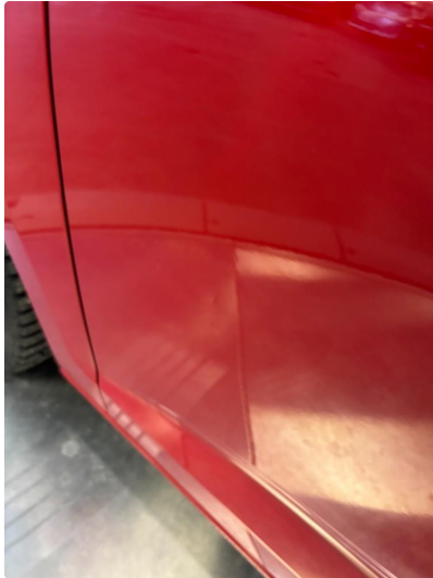
1.2 2 stk små bulker nedre framme førerdør
