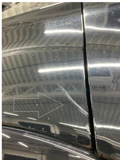
1.1 En del riper. Noen flekket m/lakk
