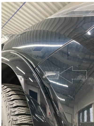
1.1 En del riper. Noen flekket m/lakk
