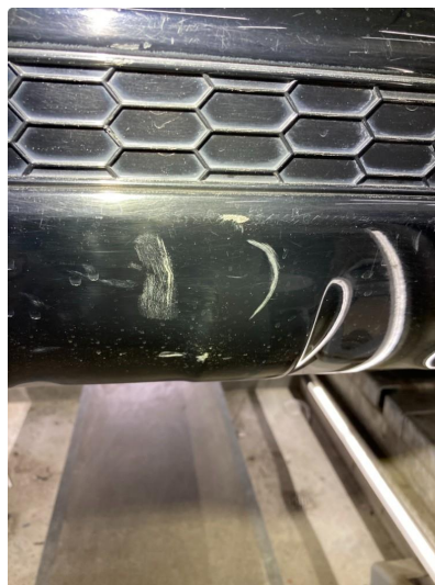
1.1 En del riper. Noen flekket m/lakk
