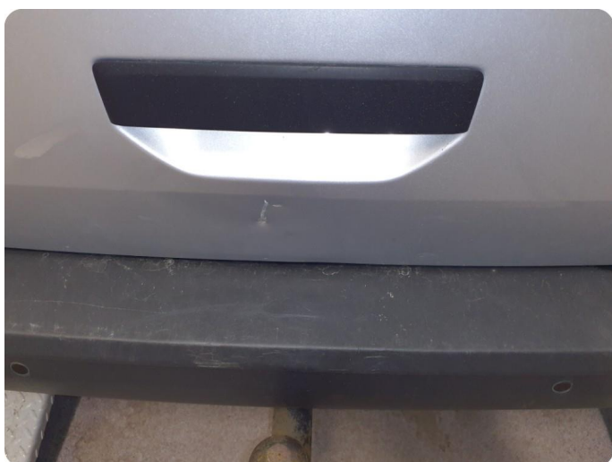
2.2 Bulk med lakkskade Inkluderer rust og flere riper
