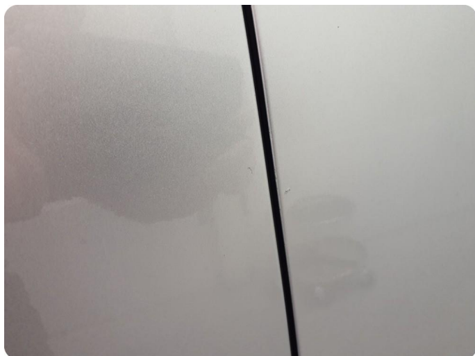
2.1 Bulk med lakkskade Inkluderer flere riper
