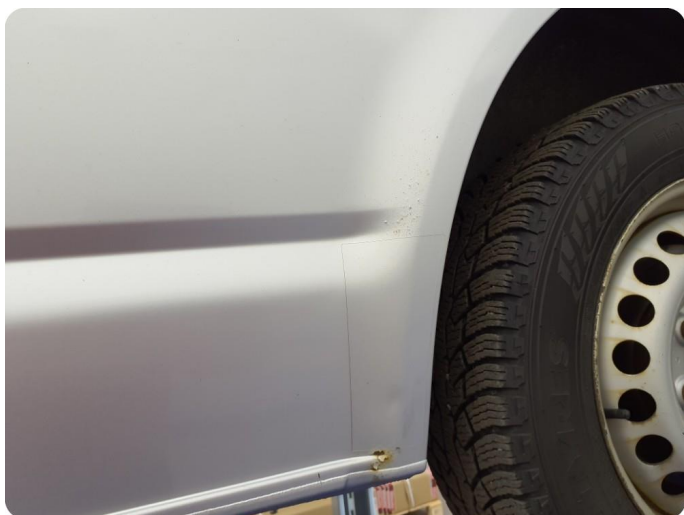
2.3 Rust Inkluderer flere riper
