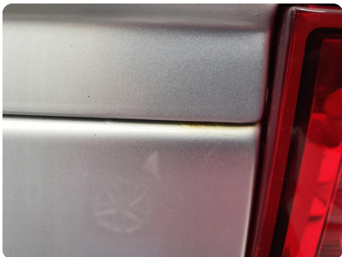
2.3 Rust Inkluderer flere riper
