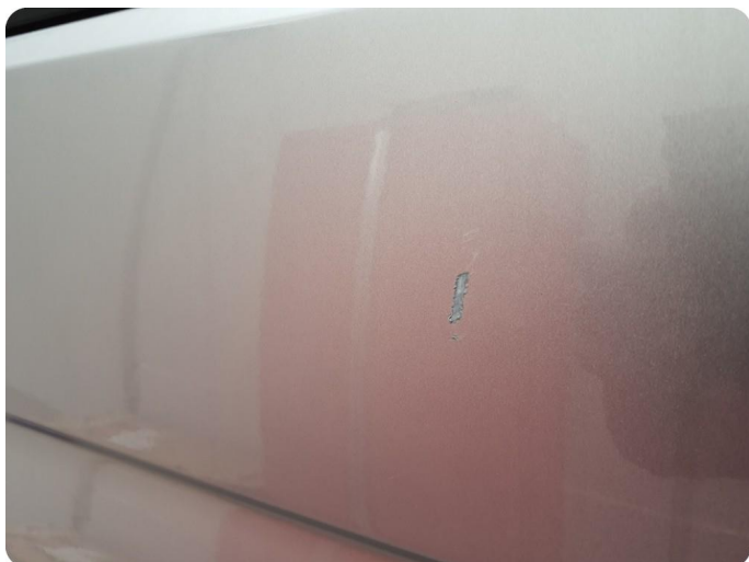
2.1 Bulk med lakkskade Inkluderer flere riper
