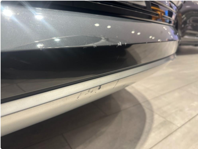
1.2 Småriper og hakk under støtfanger
