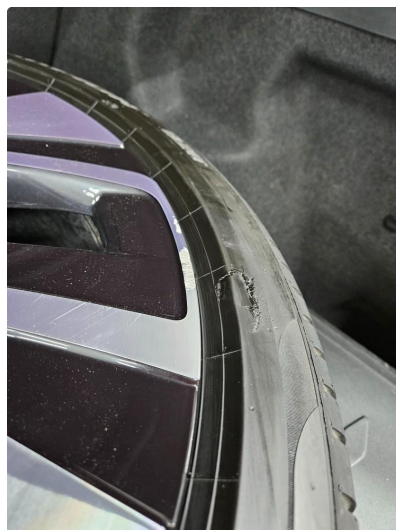
1.1 Skrubbermerker på en sommerfelg + dekk (1 stk bakhjul) dekk har ikke nedsatt funksjon eller sikkerhet, kun kosmetisk
