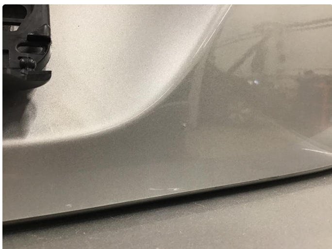
1.1 Noe zinkslipp / Småbobler /rust bakluke.
