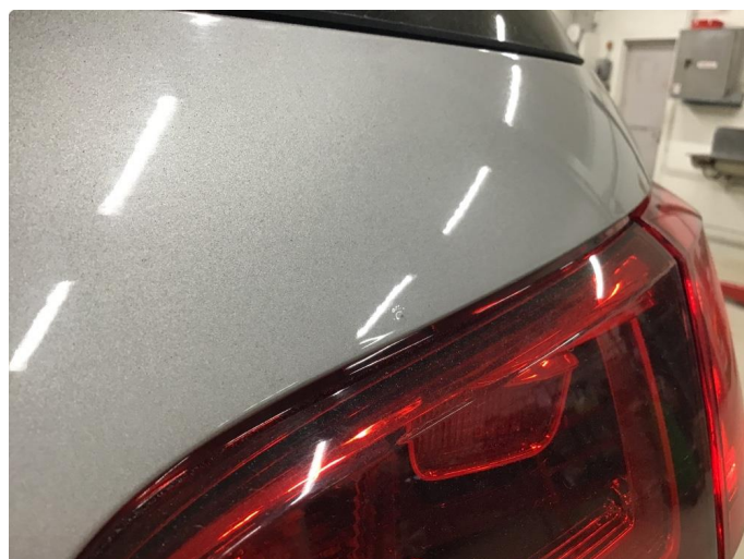
1.1 Noe zinkslipp / Småbobler /rust bakluke.
