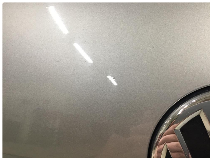
1.1 Noe zinkslipp / Småbobler /rust bakluke.
