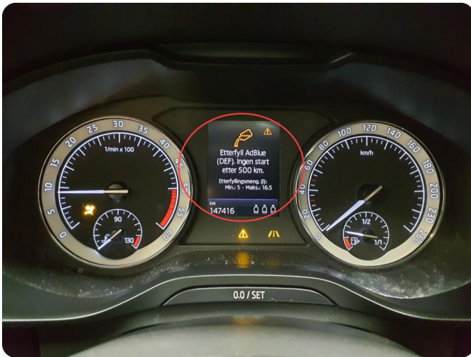
2.1 Varsellampe lyser se bilde
