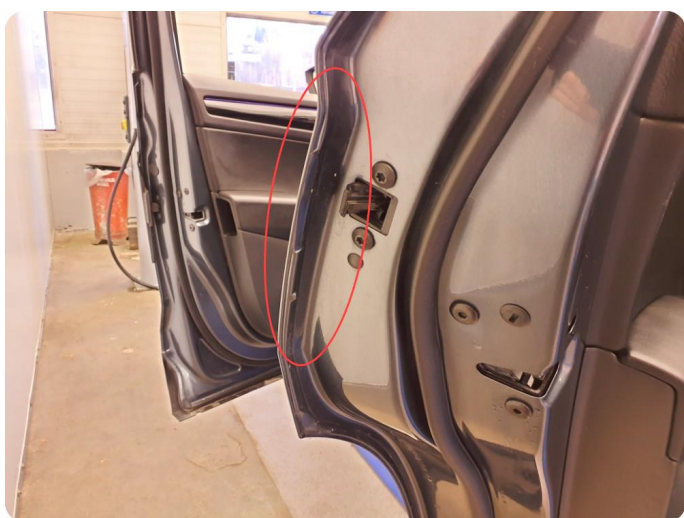
3.2 Øvrige feil Dør beskyttelse mangler
