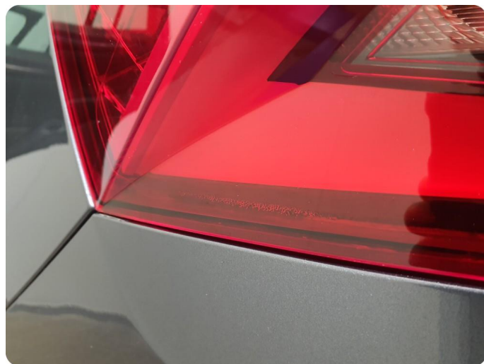
4.1 Dugg/fukt Tillegg krakelering høyre ytre
