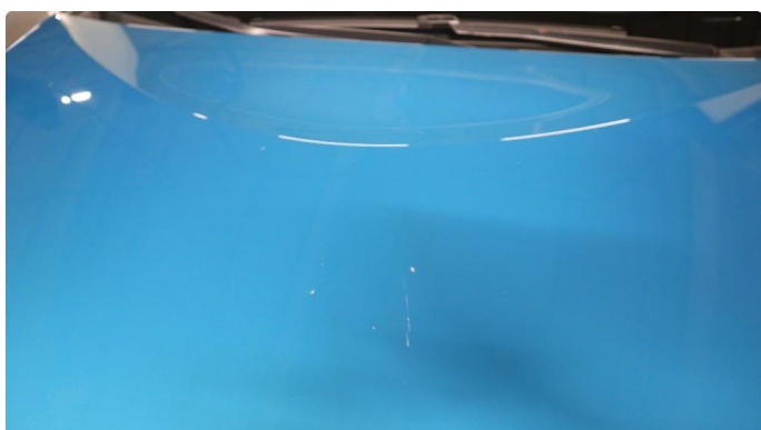
1.1 Noen riper og småbulker
