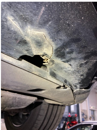
1.1 Sprekk i plate/diffusor bak. Ikke synlig når bil står nede på bakken
