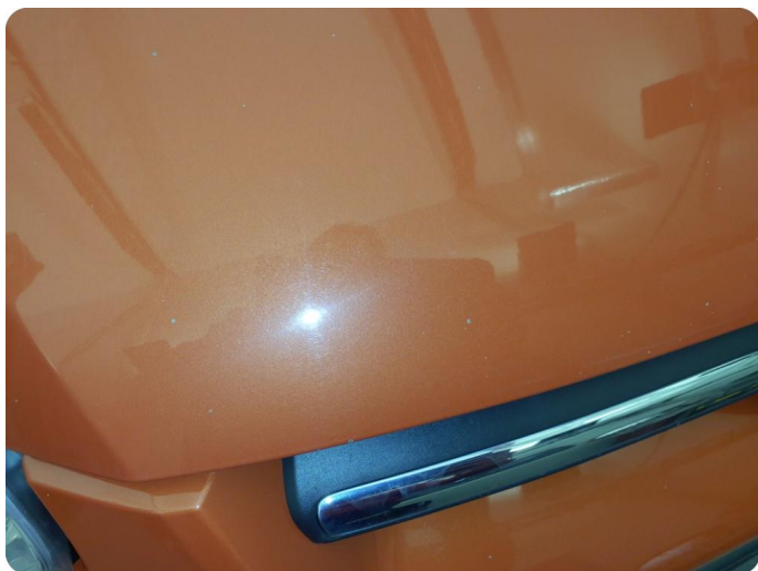
2.4 Steinsprut Med bulker
