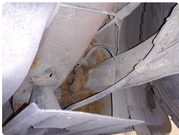
4.1 Utslitt bæreforing Fremre foringer
