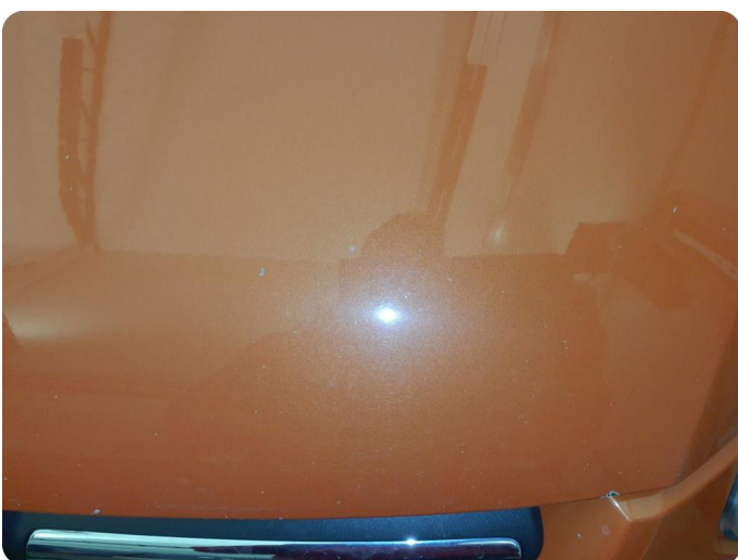
2.4 Steinsprut Med bulker
