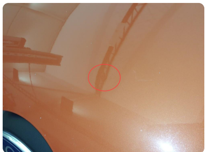
2.4 Steinsprut Med bulker
