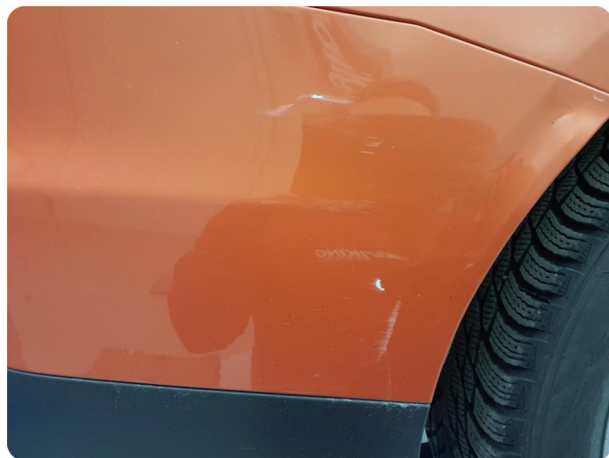
2.8 Ripe(r) ned til grunning
