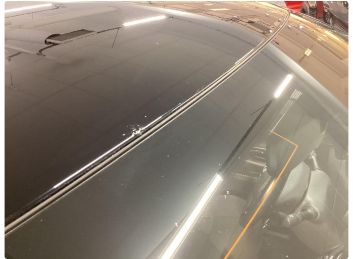
1.2 Steinsprut med rust
