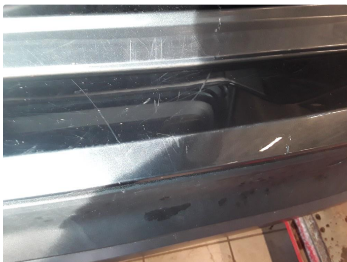
1.6 Noen sår og riper på støtfanger bak.
