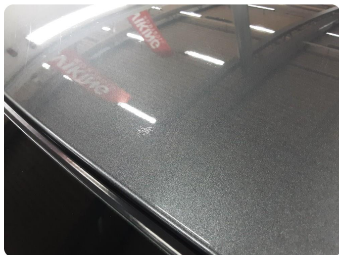
3.10 Steinsprut med rust
